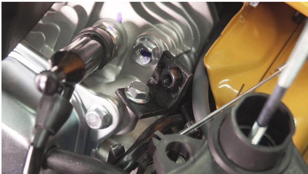
Устанавливаем кронштейн-стопор троса из комплекта. Продеваем трос в стопор.
