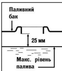
Рисунок 10. Горловина паливного баку
